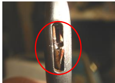
先端ジョイント部の破損
