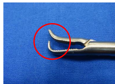
先端ジョウ部のかみ合わせ不良（変形）
