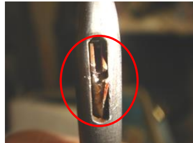
先端ジョイント部の破損
