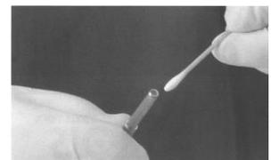
④ 次に、柔らかい布または滅菌圧縮空気を使って乾燥させる。最後にアルコールを使って、ケーブルの表面を先端の光入口を含めて乾燥させる。
